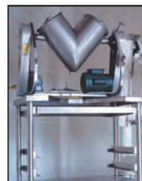
図3. 強制攪拌バー付き V 型ブレンダー 粉体をシラン処理するときに使います。
