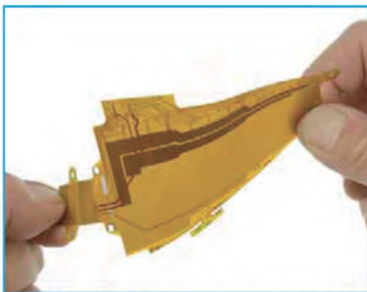
携帯電話に使われるフレキシブル多層基板にはクロロメチル化芳香族シランを反応させたポリイミドフィルムが使われています。
