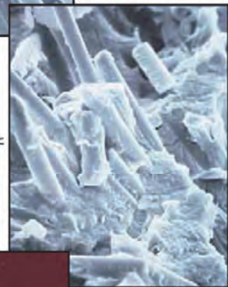
ギヤ歯は アミノシランでカップリングした ガラスファイバーと ナイロン6/6のコンポジット
