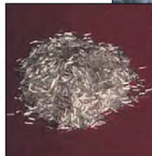
アミノシランで被覆した ガラスファイバー片は 高温の熱可塑性樹脂の 強化によく使われる
