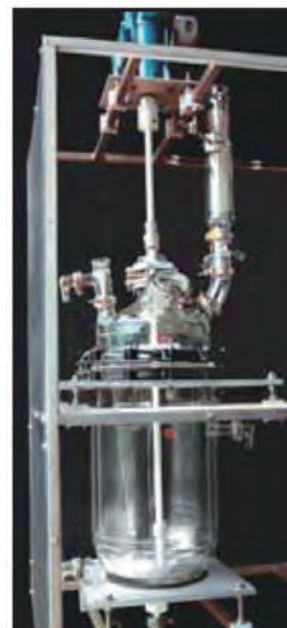
図1. 粉末をスラリーとして反応させる装置 反応後、フィルターによる分離と乾燥が必要
