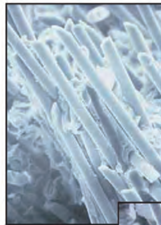
破損したギヤ歯の 走査型電子顕微鏡像
